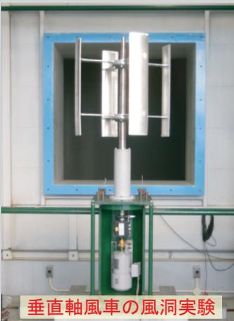
垂直軸風車の風洞実験
