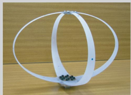
光造形法で製作した低重心風車の模型
