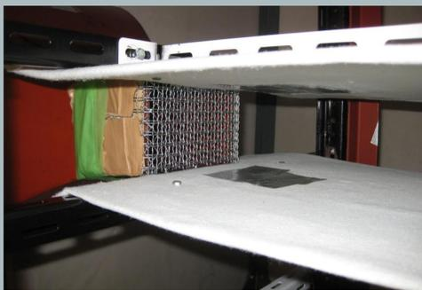
吹き出し口の上下に端板を設置して乱流格子を取り付けて乱流を発生させる。
