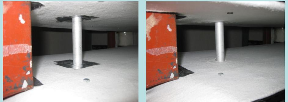
滑面円柱の時は円柱と端板のつなぎ目にアルミテープを貼って滑らかにした場合とそのままの状態の2パターンで実験を行う。
